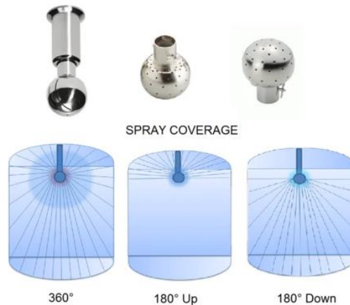
Figura 1 – Tipos de Spray Balls utilizadas para higienizar tanques de grandes dimensões Retirado de Texas process technologies, 2020
