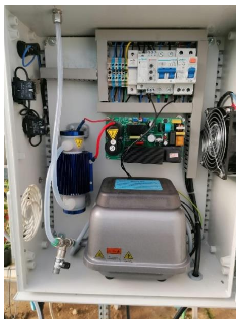
Figura 2. Protótipo de produção de ozono.
