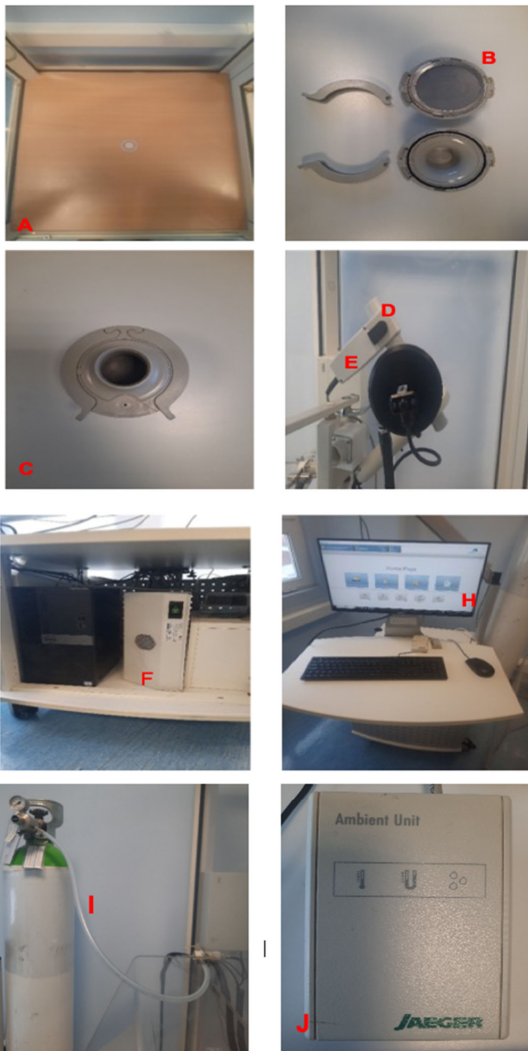
Figura 23. Vários componentes do pletismógrafo MasterScreen Body : A) Sensor e bomba de calibração (encontram-se no interior da base do pletismógrafo); B) Rede de sensibilidade; C) Pneumotacógrafo; D) Shutter ; E) Shutter Control ; F) System Box ; H) Sentry Suite ; I) Mangueira de difusão; J) Unidade ambiente
