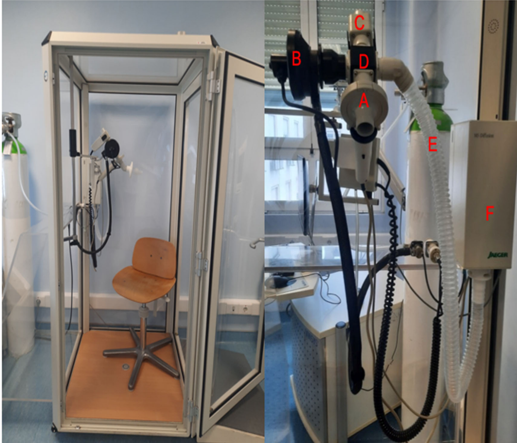
Figura 22. Pletismógrafo MasterScreen Body (lado esquerdo) e os seus componentes (lado direito): A) Pneumotacógrafo; B) Demand Valve ; C) Shutter ; D) T de suporte; E) Traqueia ou tubo flexível; F) Analisador de gases
