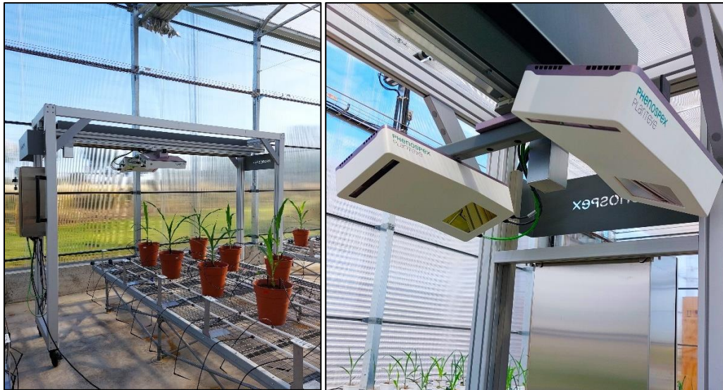
Figura 7 – Equipamento TraitFinder (esquerda), Sensores PlantEye (direita).
