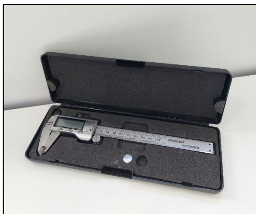
Figura 9 - Paquímetro digital usado para a medição final do diâmetro dos caules.
