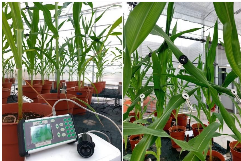
Figura 8 – Fluorímetro Handy PEA+ (lado esquerdo); Clipes por onde é efetuado o pulso de luz sobre a área da folha exposta.
