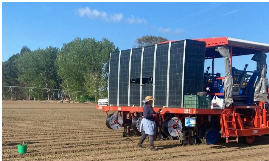
Figura 11 - Fotografia da transplantadora em ação.
