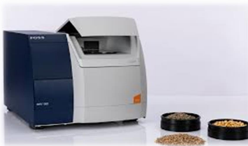
Figura 24 Equipamento NIRS™ DS3 FOSS utilizado para a aquisição dos espectros NIR das diferentes amostras analisadas.
