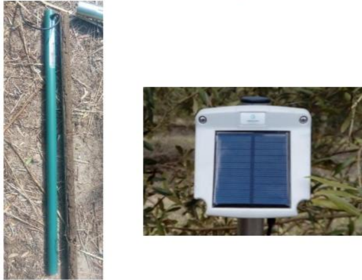
Figura 7: Esquerda sonda de profundidade, direita logger; Fonte: (Hidrosoph 2021)
