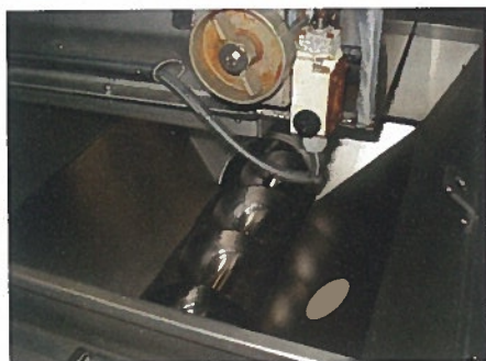
Figura 6 - Sem-fim da tremonha da bomba de massas sem protecção.
