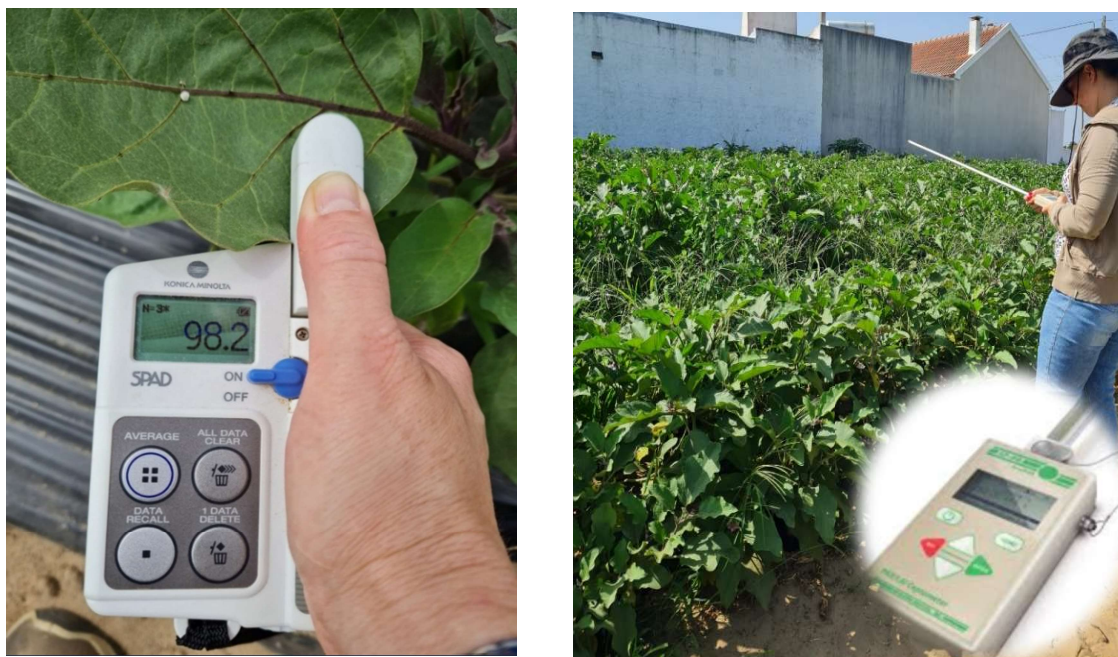
Figura 12 – Medição da clorofila com SPAD (esquerda) e medição IAF com ceptómetro (direita).
