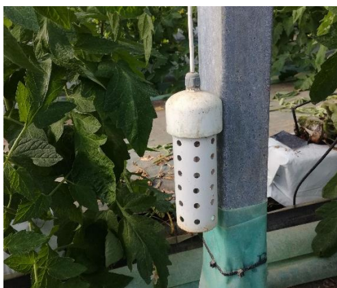
Figura 6. Sonda de temperatura (original do autor).
