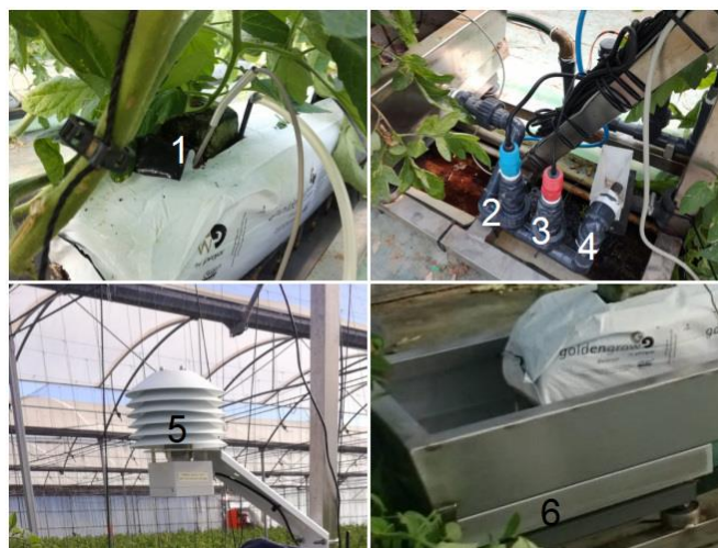
Figura 29: Conjunto dos sensores do equipamento (1- sonda RESIPREL PT-100; 2- sonda PH HI1001; 3- sonda EC HI3002; 4- pluviômetro de báscula PM1; 5- sonda DHT22; 6- célula de carga RSC-1)
