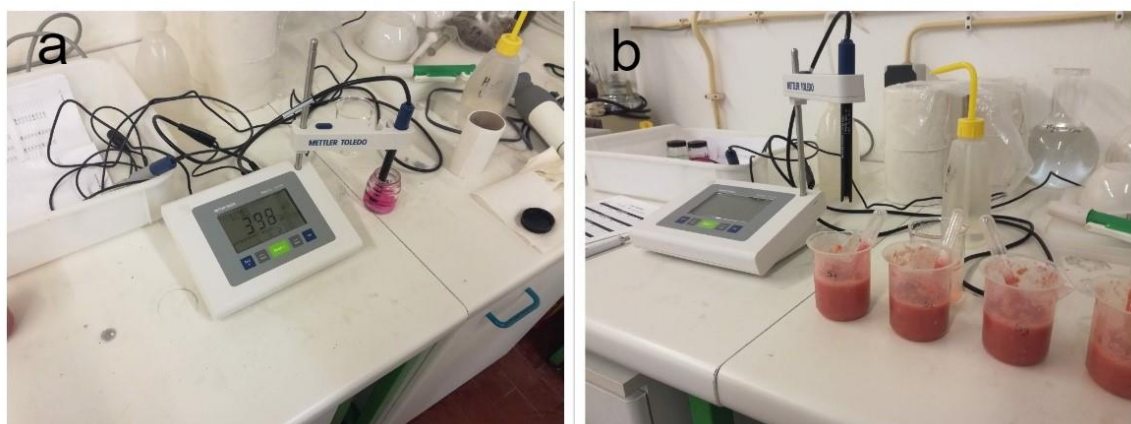
Figura 9. Calibração do condutivímetro (a). Leitura da amostra (b) (original do autor).
