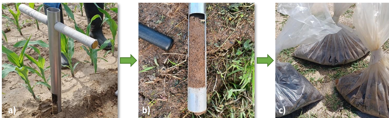
Figura 39 - Procedimento de recolha de amostras de solo: a) Sonda de solo; b) Recolha de solo a 20cm de profundidade; c) Separação e identificação das amostras.
