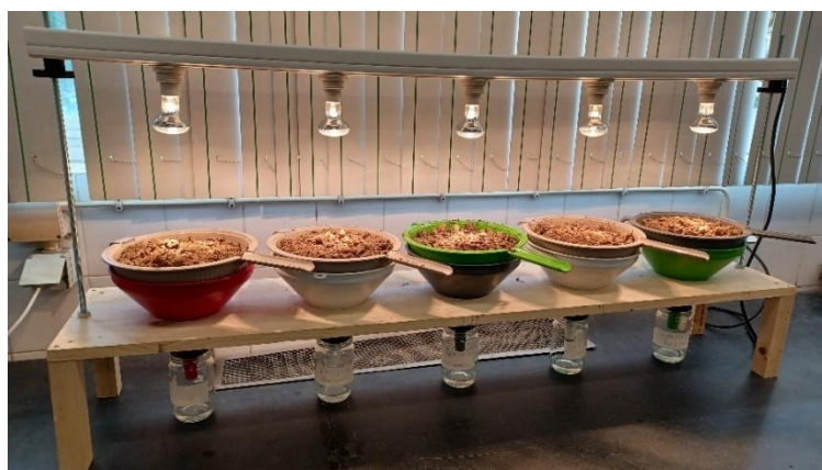
Figura 40 - Extração dos microartrópodes em extrator do tipo Berlese-Tüllgren .
