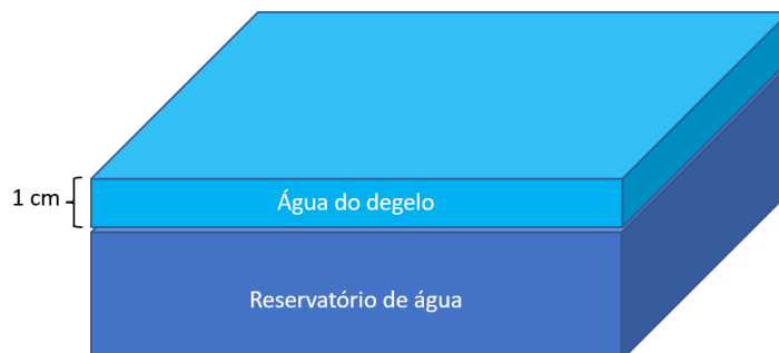
Figura 2. Subida, em 1 cm, do nível de água de um reservatório devido ao degelo.
