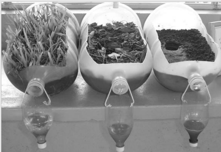
Figura 21. Aparato experimental sobre a fertilidade dos solos
