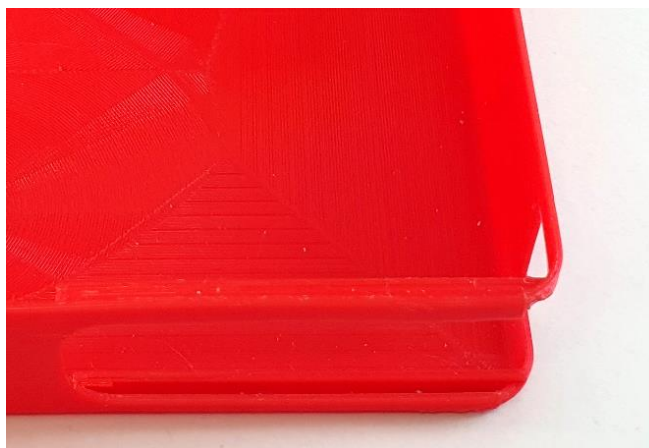
Imagem 55 - Detalhe da qualidade de impressão da nova caixa
