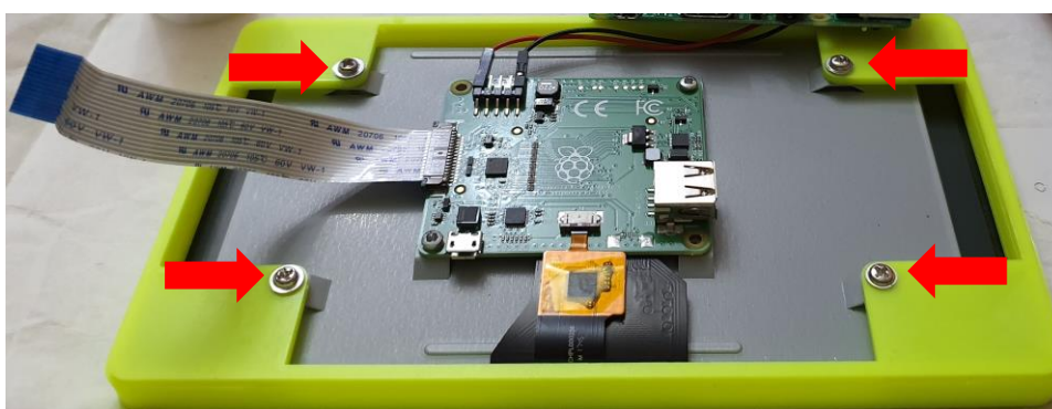
Imagem 82 - Fixação do ecrã à moldura
