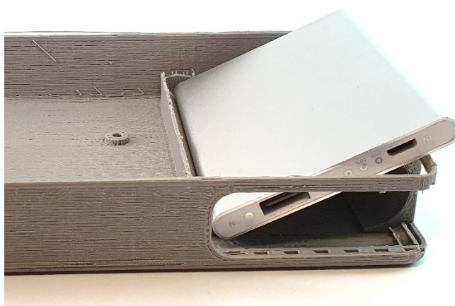
Imagem 52 - Teste com powerbank com espessura reduzida (e menor capacidade)
