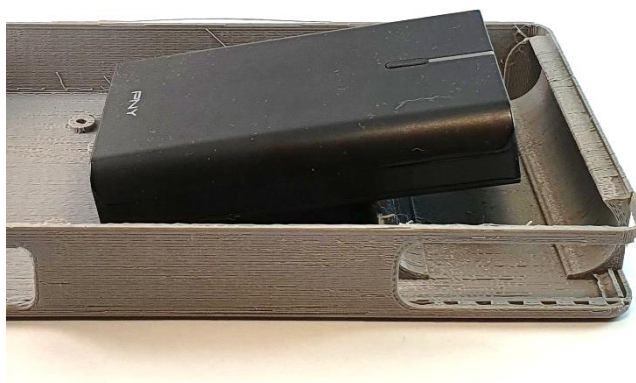
Imagem 53 - Teste com powerbank com espessura aumentada (e maior capacidade)
