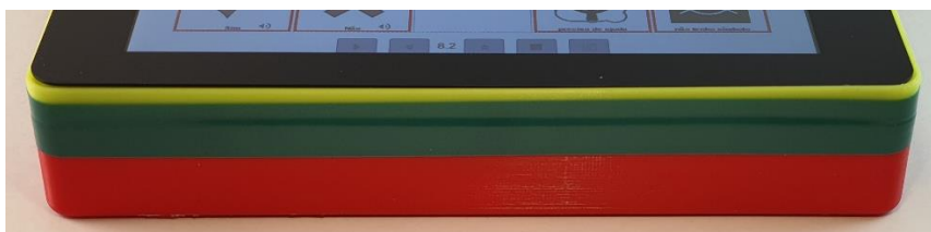
Imagem 87 - Detalhe da união com fita adesiva entre as duas partes principais da caixa
