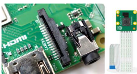
Imagem 36 - Conector CSI e câmara de vídeo com cabo
