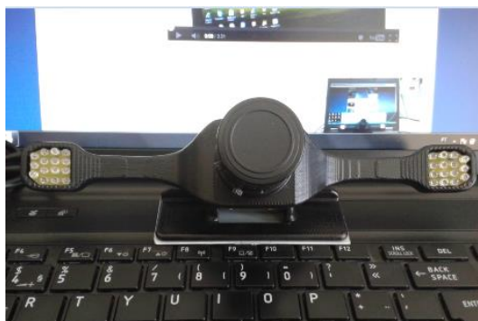
Imagem 12 - Exemplo de sistema de deteção do movimento das pupilas para ativação de sistemas de CAA 20
