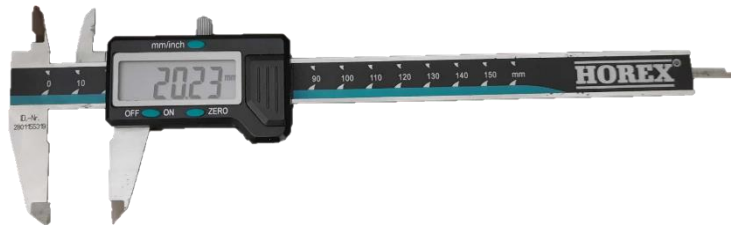
Figura 17 - Paquímetro digital utilizado para medir a espessura dos lançamentos
