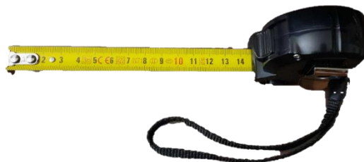
Figura 16 - Fita métrica utilizada na medição do comprimento dos lançamentos
