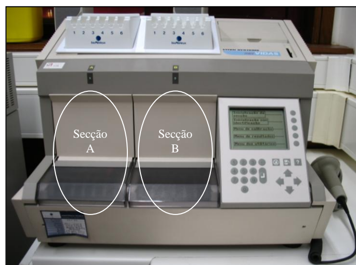
Figura 1- Equipamento mini VIDAS com as duas secções, A e B, que o compõem.
