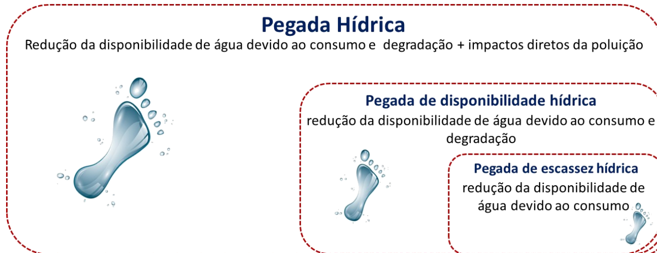
Figura 4: Ilustração esquemática da avaliação da pegada hídrica adotada no âmbito da ISO 14046:2014. Adaptado de Anne-Marie Boulay, WULCA.
