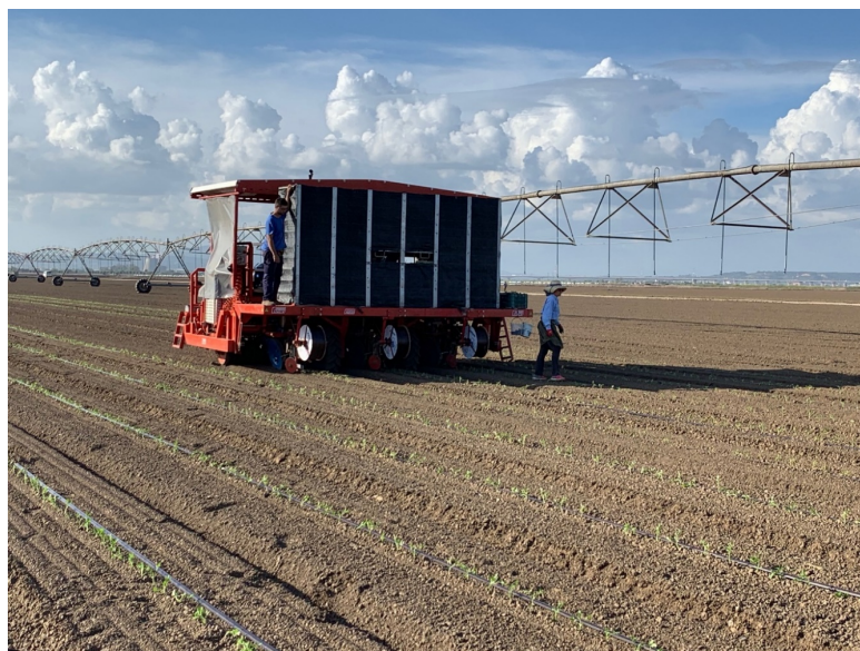
Figura 3 - Plantação (plantadora automotriz)
