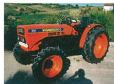
Figura 6 - Tractor vinhateiro sem qualquer estrutura de segurança contra reviramento.
