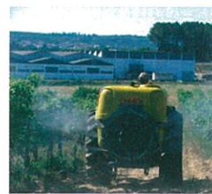
Figura 8 - Tratamento fitossanitário com pulverizador a pressão de jacto transportado, montado em tractor sem cabina.
