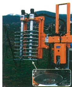
Figura 7 - Pré-podadora (pormenor da peça móvel de corte).
