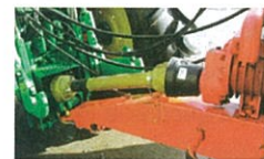
Figura 12 - Veio de cardans devidamente protegido.
