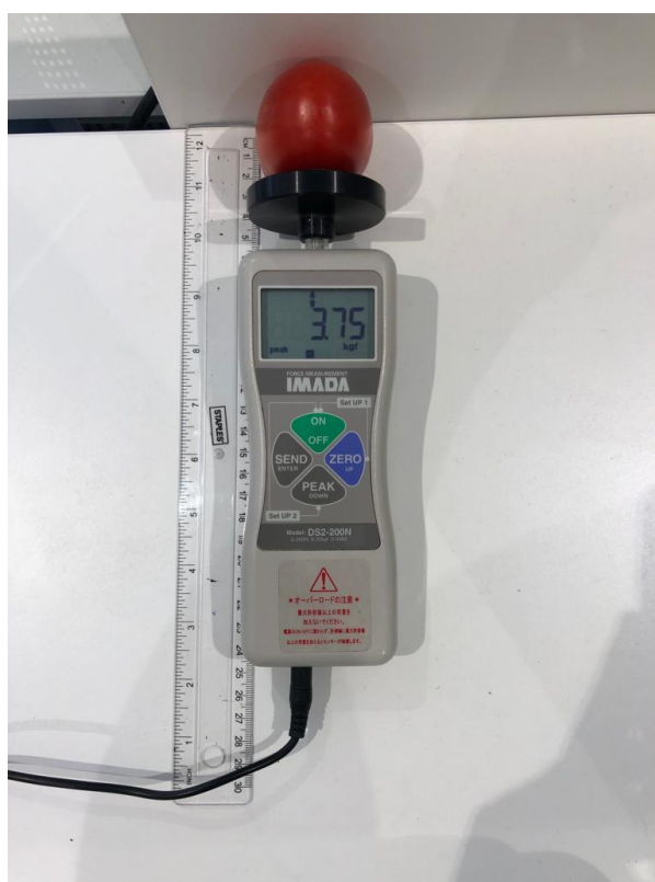
Figura 24 - Avaliação da firmeza dos frutos através do medidos de compressão (Force Measurement IMADA).
