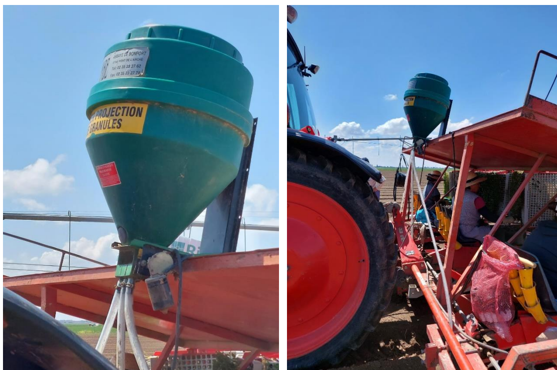
Figura 17 – Microgranulador-doseador acoplado à plantadora de copos de três linhas.
