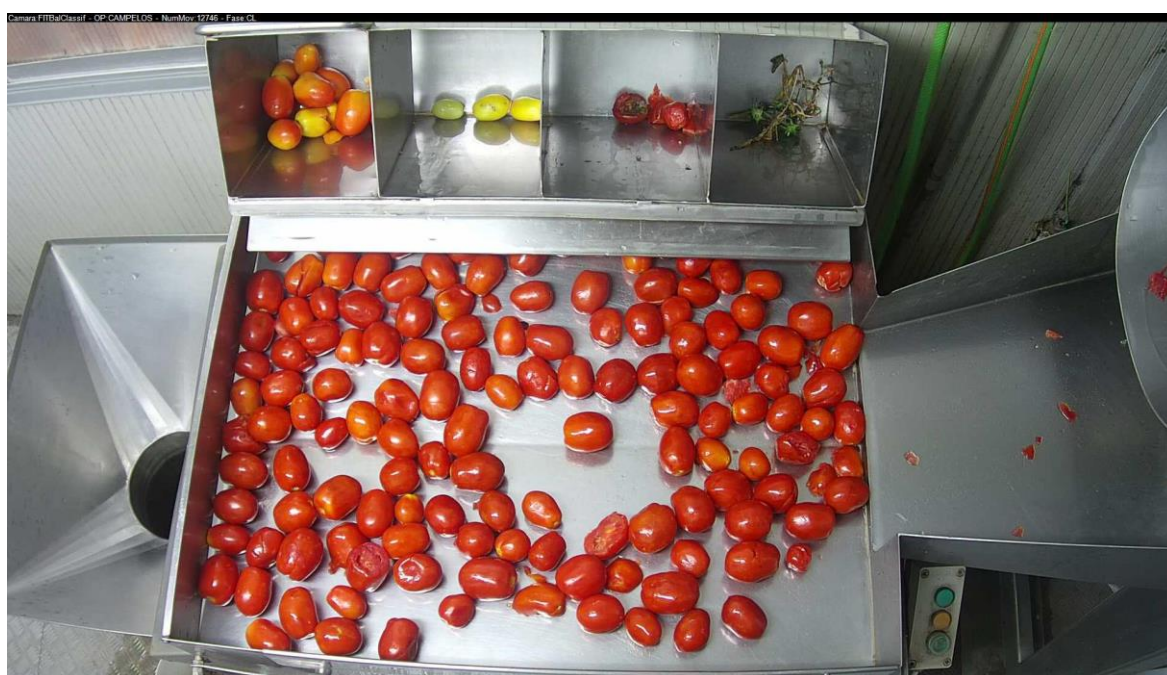
Figura 23 - Processo de classificação do tomate (exemplo).
