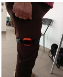
Figura 2 – Imagem ilustrativa da colocação do sensor inercial
