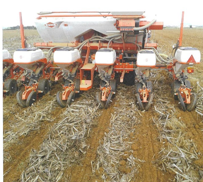
Figura 9 - Sementeira do milho grão com semeador mono-grão, de 6 linhas, marca "Kuhn" no sistema de mobilização na zona, na subparcela testemunha (MZT).
