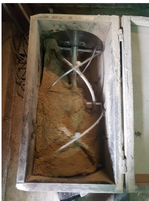
Figura 5: Misturador experimental utilizado para uniformizar a distribuição do bromoil no alimento base.
