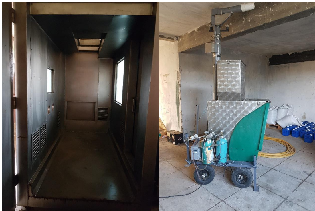
Figura 4: Câmara respiratória e sistema GreenFeed, utilizado nas instalações do INIAV-Fonte Boa.
