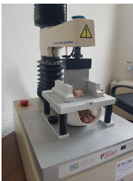
Figura 8: Determinação da força de corte em texturómetro.
