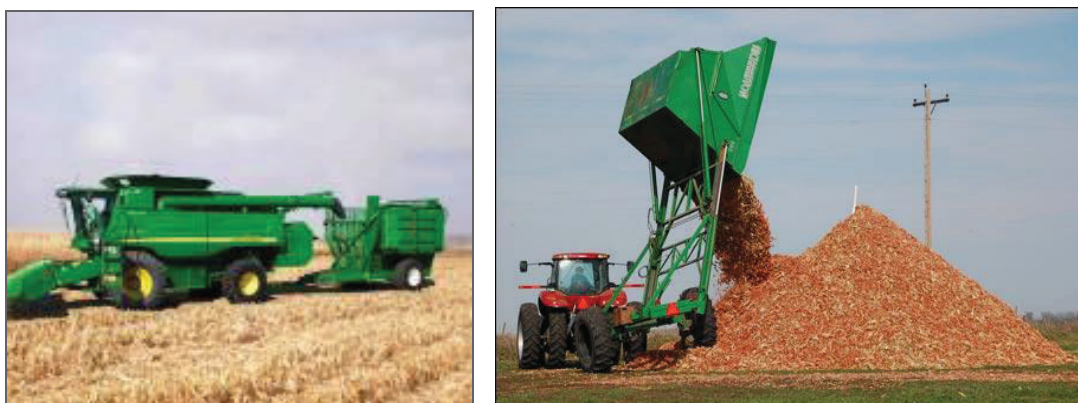
Figura 14 - Equipamentos para recolha de carolo da ceifeira-debulhadora (Fonte: https://www.no-tillfarmer.com/pages/News---Deere,-Hillco-Design-Corn-Cob-Collector.php . Consulta em 10 de outubro de 2014).
