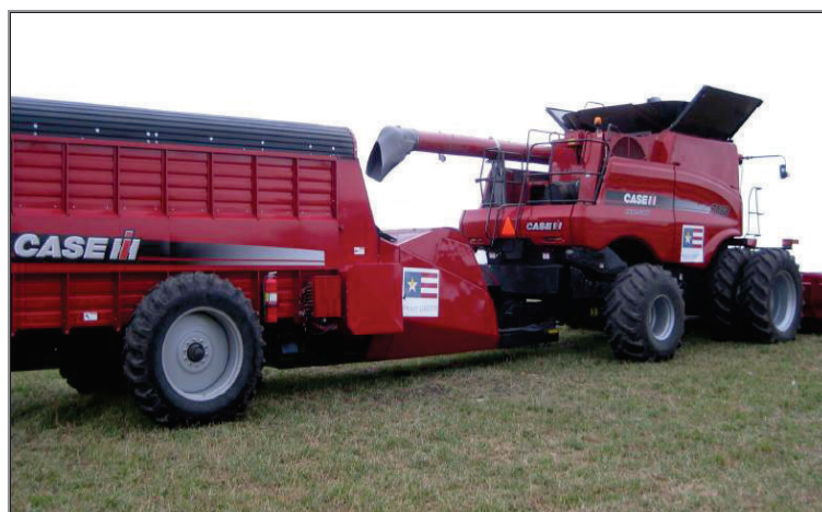
Figura 15 - Equipamento para recolha de resíduos provenientes colheita, tais como o carolo.
