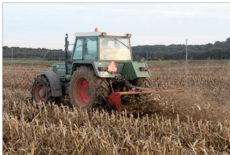
Figura 8 – Destroçamento das palhas de milho com um destroçador visando o seu aproveitamento.
