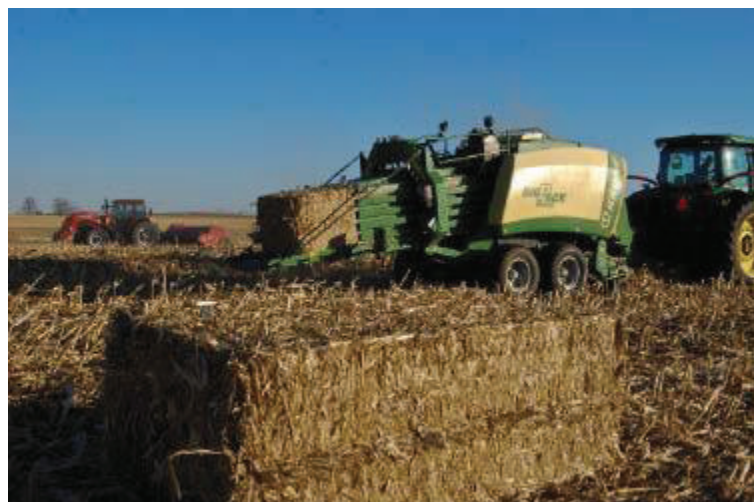
Figura 10 – Utilização de enfardadeira de fardos paralelepípedicos para enfardação da palha (Fonte: http://farmprogress.com/library.aspx/gets-payment-corn-stover-33/36/1415 , consultado em 10 de outubro de 2010.)
