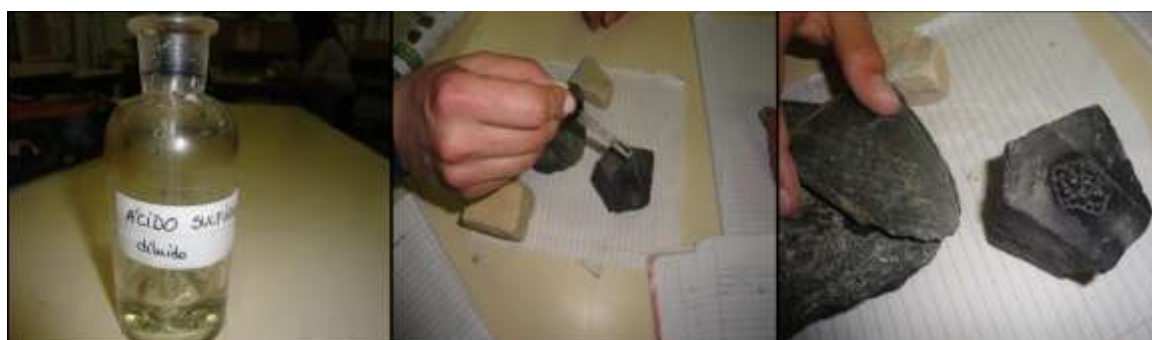
Figura 10 – Verificação da efervescência numa amostra de rocha.
